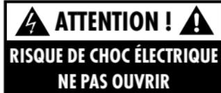
*Le symbole de l'éclair avec une flèche à l'intérieur d'un triangle équilatéral vise à alerter l'utilisateur de la présence d'une „tension dangereuse“ non isolée à l'intérieur du boîtier de l'appareil qui peut être d'une magnitude suffisante pour constituer un risque de choc électrique.*
