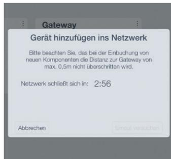
**Bitte beachten Sie, dass bei der Einbuchung der LED Lampen der Abstand von 0,5m zwischen Gateway und der LED Lampen nicht überschritten wird.**
